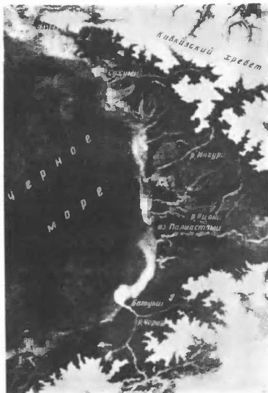
Вынос мутных вод в Черное море. Снимок может быть использован для оценки поступления наносов.
